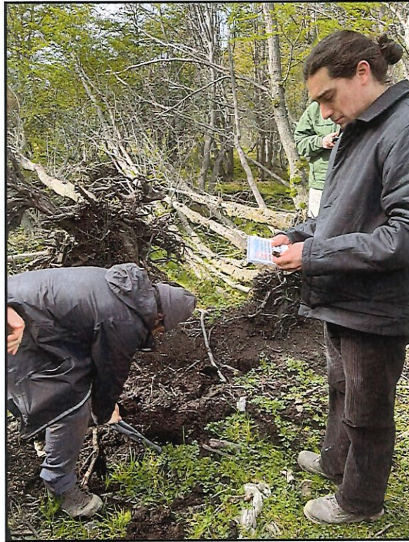
Fig. 10. Evaluación de presencia de suelos hídricos a través de la excavación de calicatas y comprobación de horizontes con extracto de escala Munsell presente en la Guía de Delimitación de Humedales del Ministerio del Medio Ambiente
